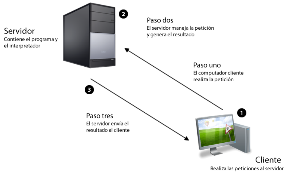
Figura 2.5. Esquema simple del modelo cliente-servidor.
